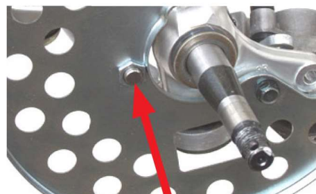
CAPTEUR VISSÉ SUR FLASQUE DE FREIN
